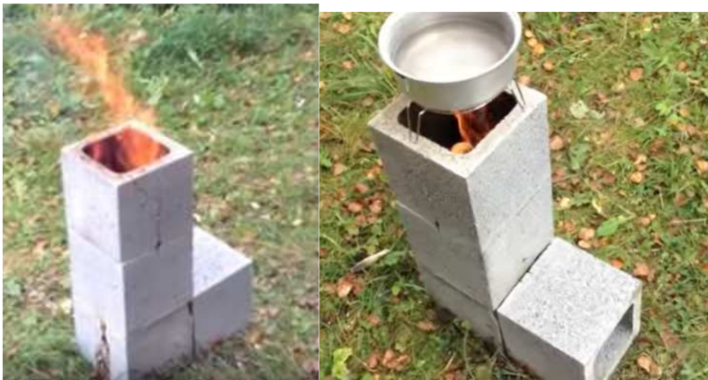
Exemple de four avec parpaings « cheminée »
